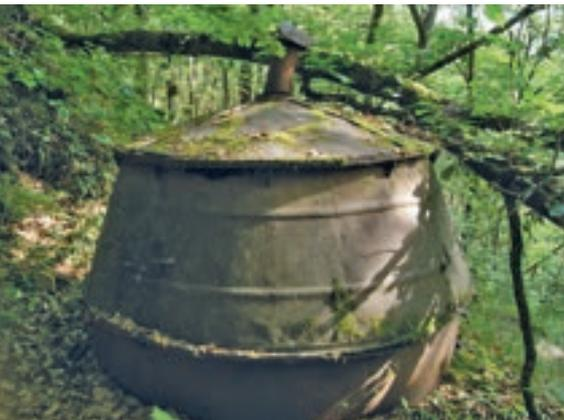
Exemple de four à charbon cylindrique
